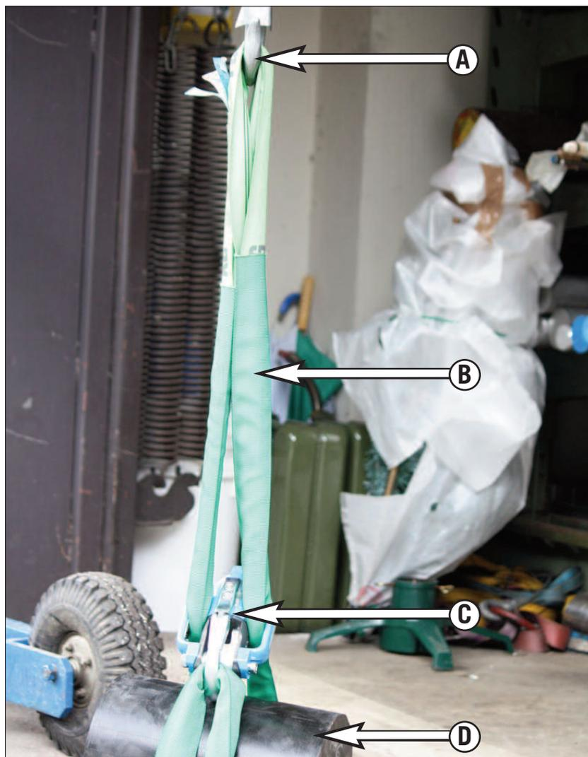
Mode d'attache : « Traction par manille/alésage »
