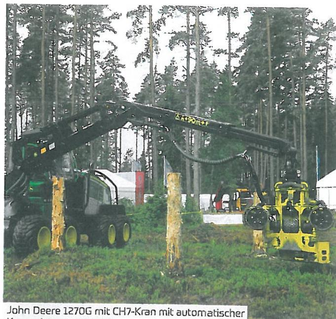
John Deere 1270G mit CH7-Kran mit automatischer Kranspitzensteuerung
